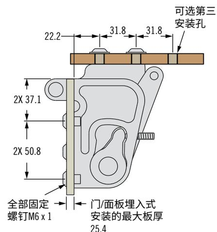
注意: 墙板安装以左手装配显示。其他对照的几何“A”数据显示为右手组件
